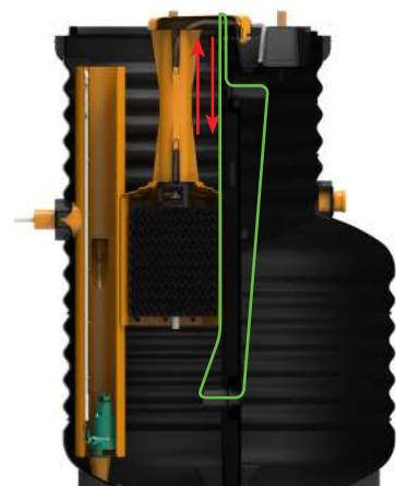
Схема прочистки нижнего патрубка
